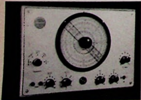
UKW- und Fernseh-Prüfender Videotest (Nordfunk). Frequenzbereich 5...250 MHz, Zf-Bereiche gespreizt. Bildmodulation durch Balkenmuster
